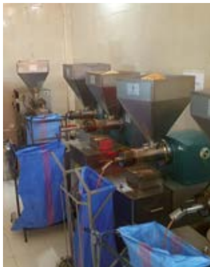
Gewinnung von Arganöl mit Spindelpressen.
